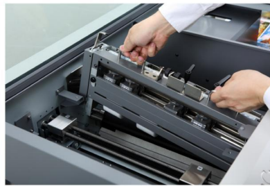
Unità di perforazione
